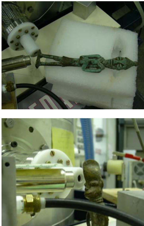
Fig.3 Vista do arranjo experimental usado na análise das estatuetas metálicas da coleção africana do MAE(A – cima - e B - baixo).
