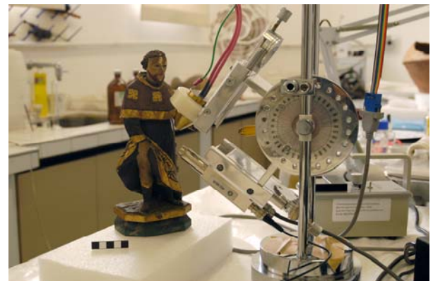
Fig. 10 O sistema portátil de EDXRF posicionado para a medida de uma escultura em madeira policromada, no Laboratório de Conservação do MAE/USP.
