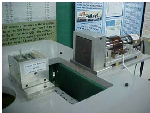
Fig.3 Mesa de transmissão de raios gama com fonte de ^{241}\text{Am} , com movimentação XZ micrométrica da amostra e sistema automatizado de tomada de dados.
