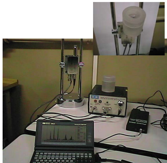
Fig.1 O sistema portátil de EDXRF com detector não-criogênico de Si-PIN para uso com fonte radioativa anelar de ^{238}\text{Pu} . No detalhe o sistema de excitação montado no detector.
