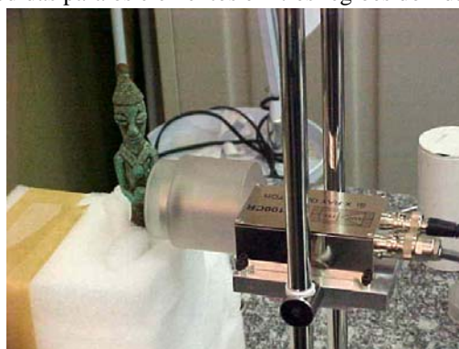
Fig. 5 Medida do Edan A EDXRF portátil.
