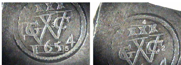
Figura 1 – Imagem de microscopia ótica mostrando as 5 regiões selecionadas para observação MEV.
