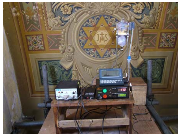
Fig.1 O sistema portátil de EDXRF posicionado para a medida de uma região da pintura mural na parede sem infiltração, montado sobre um andaime no topo de uma das capelas da igreja.
