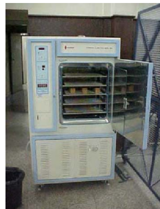
Fig. 3 Câmara de climatização aberta para colocação dos corpos-de-prova
