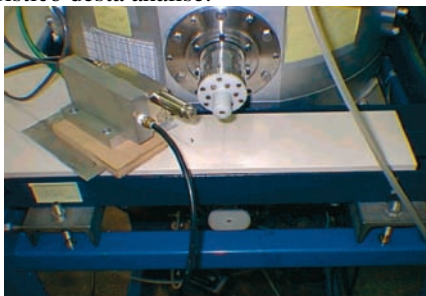
Fig.1 Vista do arranjo experimental do feixe externo e do detector de raios-X montados no LAMFI.
