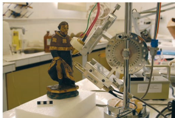
Fig.1 O sistema portátil de EDXRF posicionado para a medida de uma escultura em madeira policromada, no Laboratório de Conservação do MAE/USP.
