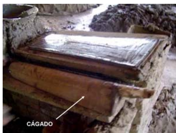
Fig.13 Cágado na espera do pano da telha
